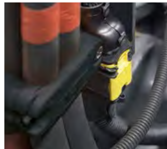
Interfaz del tablero portahorquillas
